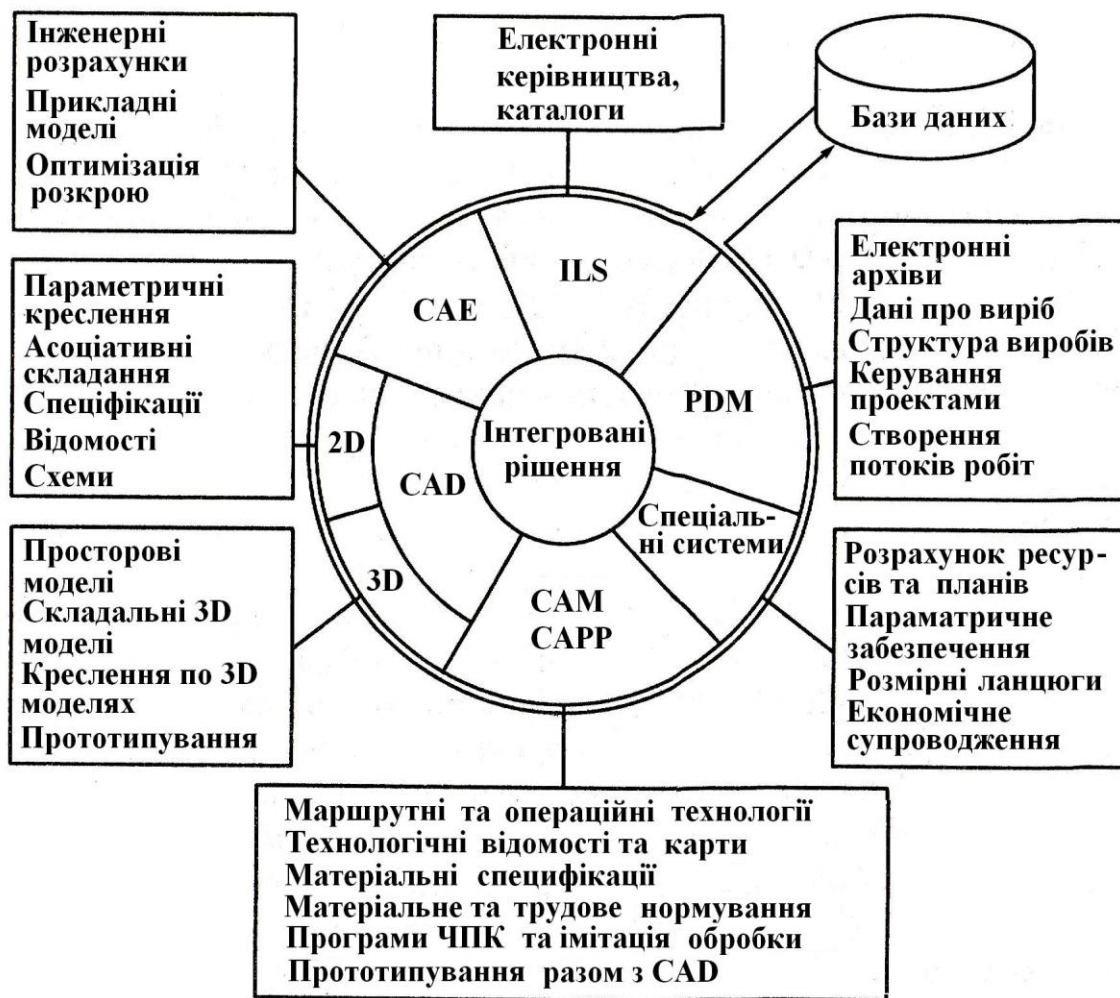
Рисунок 1.3 – Функції основних систем CALS-технологій машинобудівного підприємства
